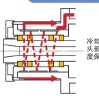
冷却轴承壳外缘以及主轴 头部外缘, 使主轴头部温 度保持均匀。
